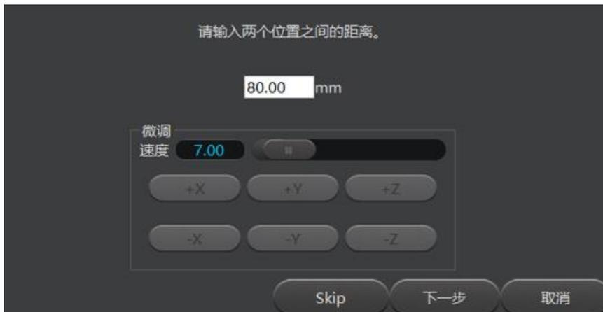
图 5.147 设置两个校准点之间的距离
