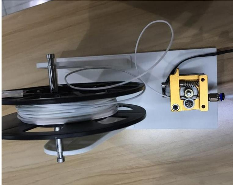
图 5.105 将耗材和挤出机放置于耗材支架
