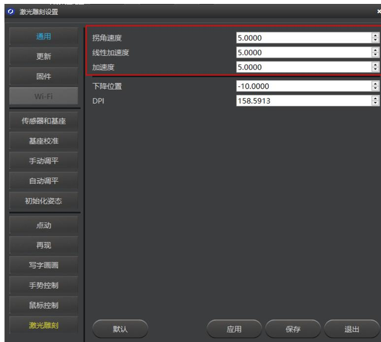
图 5.81 设置激光雕刻相关参数
