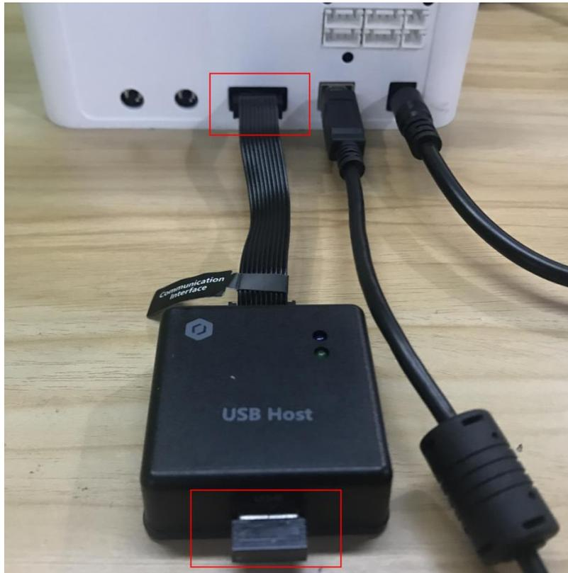
图 5.165 连接 USB Host 模块
