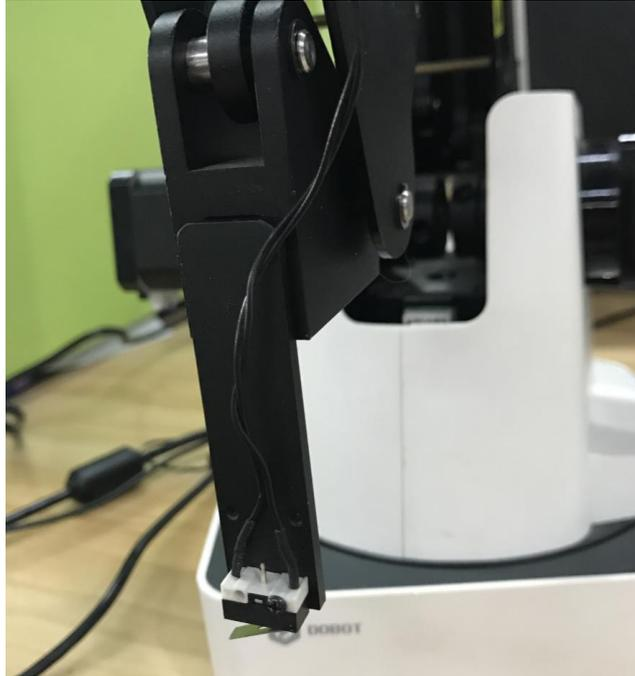
图 5.150 调平工具安装方向
