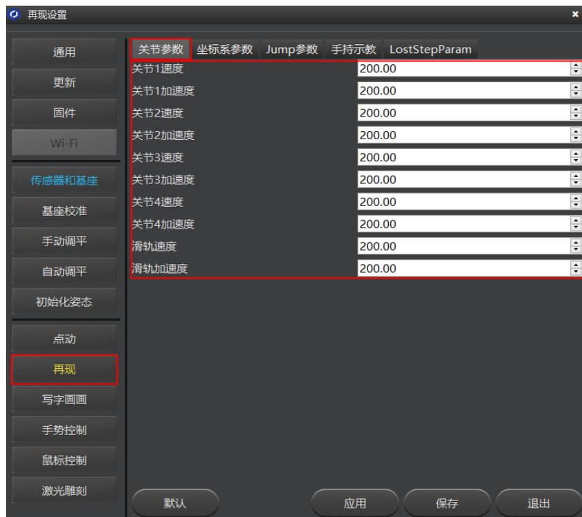
图 5.25 调整再现的速度和加速度
