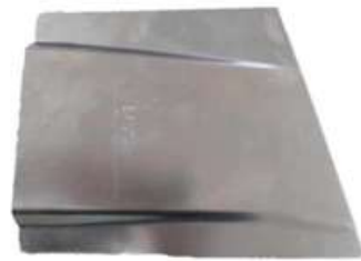
图 3 模拟左前纵梁外板 C
