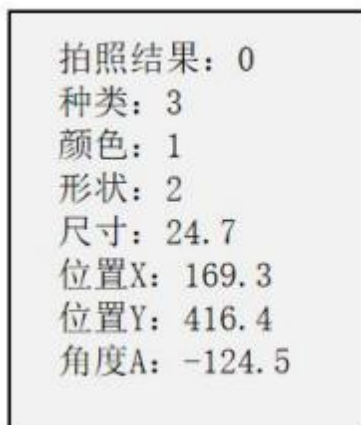
图 12 SCADA 组态智能相机参考界面
