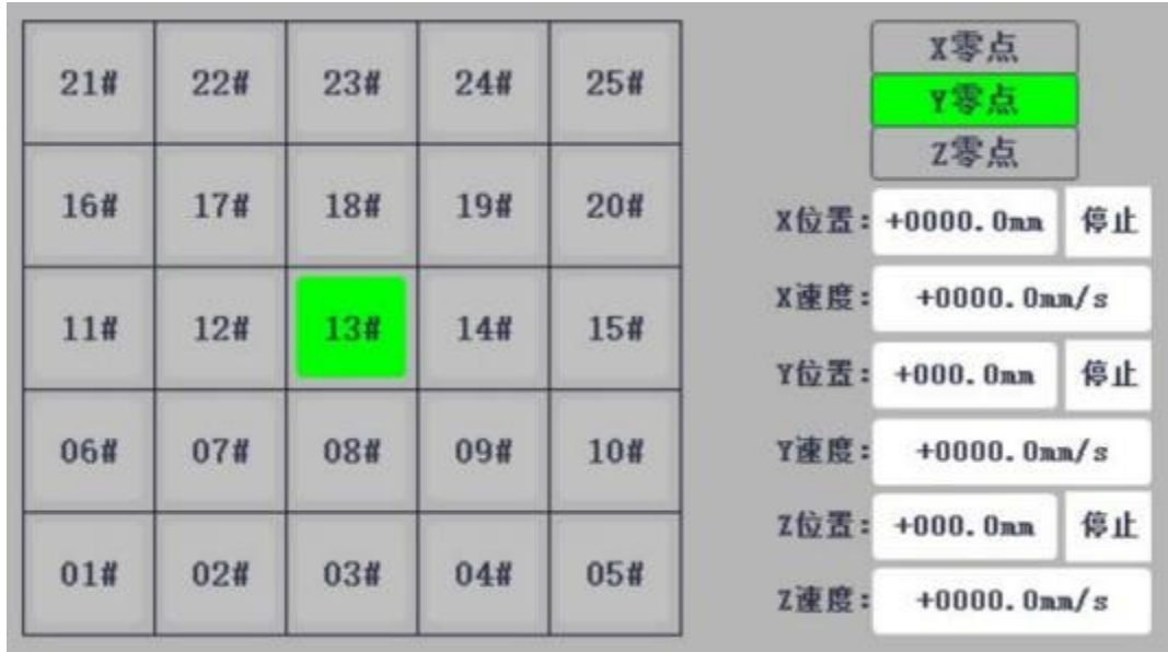
图 7 实时显示机器人和仓位数据变化参考界面
