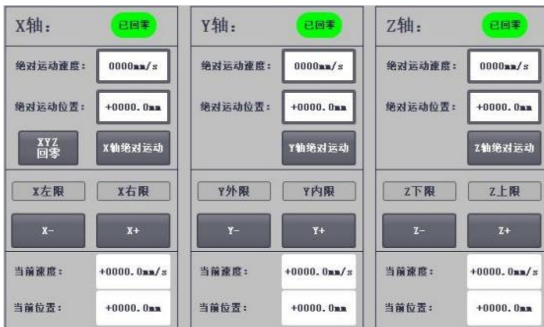
图 5 智能仓储区机器人各轴功能调试参考界面
