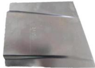
图 3 模拟左前纵梁外板 C
