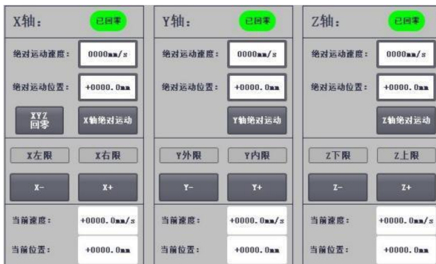
图 6 智能仓储区机器人各轴功能调试参考界面
