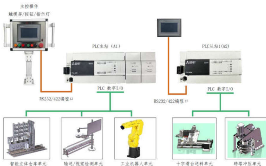
图 1-2 控制系统网络拓扑图
