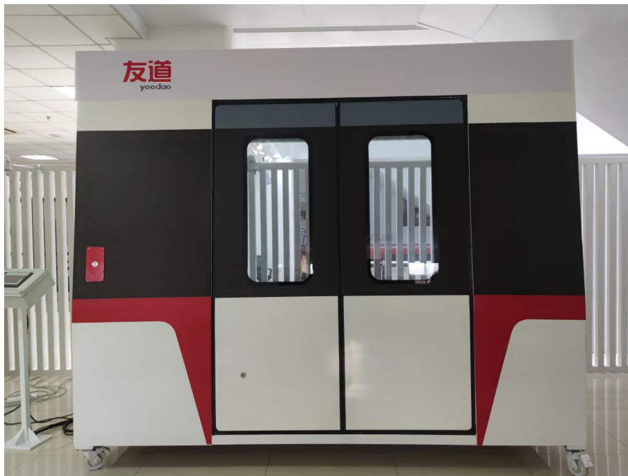
图 4 客室车门安装框架
