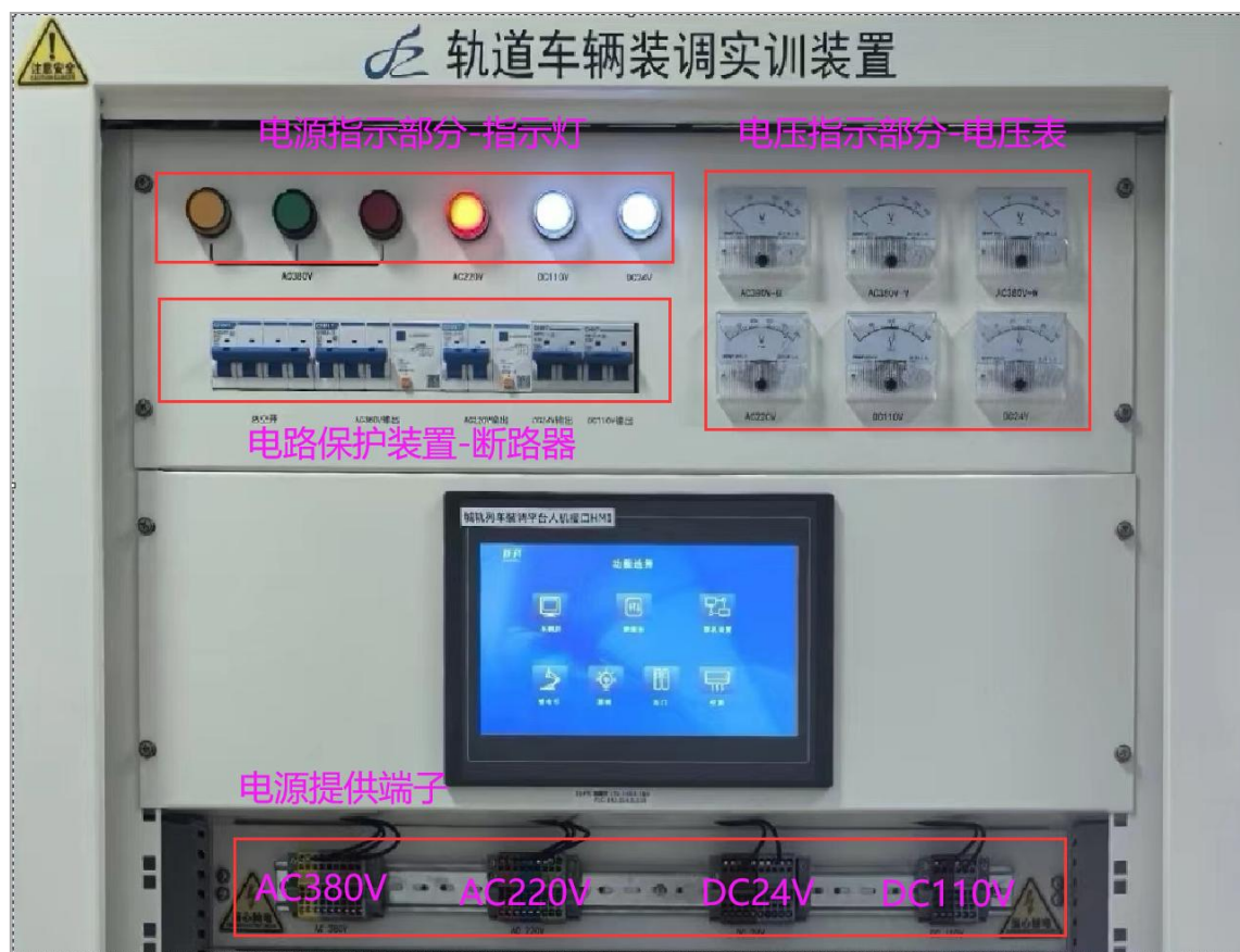
图 4 电气控制柜体电源布局
