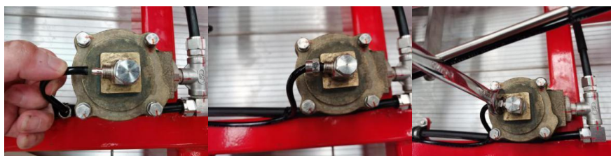
图 9-10 螺纹接头连接结构的气路软管安装和拆卸
