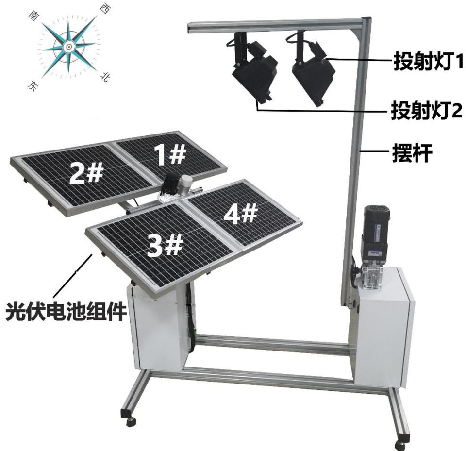
图2 光伏发电单元
